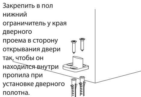
Закрепить в пол нижний ограничитель у края дверного проема в сторону открывания двери так, чтобы он находился внутри пропила при установке дверного полотна.
