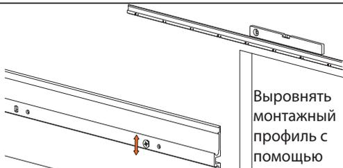
Выровнять монтажный профиль с помощью уровня и зафиксировать его саморезами.
