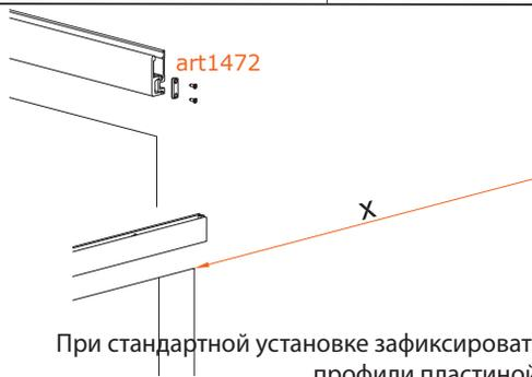
При стандартной установке зафиксировать профили пластиной.
