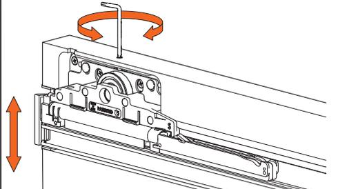
Отрегулировать положение двери с помощью верхних отверстий.
