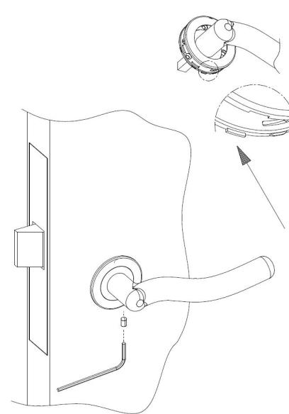
ВНИМАНИЕ: ПРИ ИСПОЛЬЗОВАНИИ ШУРУПОВЕРТА УСТАНОВИТЬ СКОРОСТЬ НА МИНИМУМ, ЧТОБЫ ИЗБЕЖАТЬ ПОВРЕЖДЕНИЯ РОЗЕТКИ
